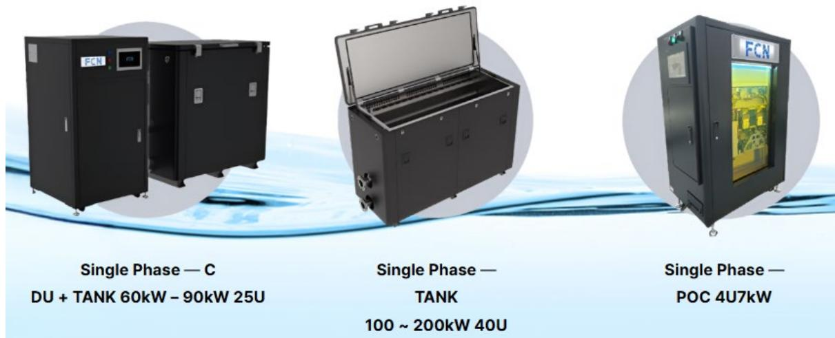
싱글 페이즈 방식은 냉각 액체가 기화되지 않고 항상 액체 상태를 유지하며 열을 전달하는 방식입니다. IT 장비에서 발생한 열을 흡수한 액체가 내부 냉각수 회전 시스템을 통해 식혀지며 순환합니다. 액체 증발이 거의 없어 관리가 용이한 '개방형 수조' 구조를 사용할 수 있는 것이 특징입니다.
